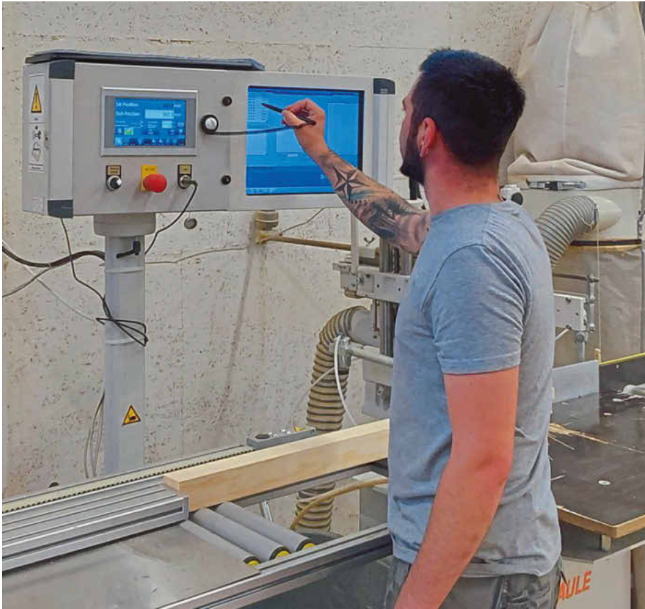
/ Der materialoptimierte Längenzuschnitt der Kanten erfolgt einfach mit einer CNC-Achse als Anschlag an der Kappsäge. Die Daten liefert die Software Digismart als Schnittstelle von der Arbeitsvorbereitung in die Werkstatt.
