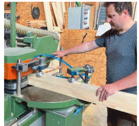
/ Die Querbearbeitung der Blendrahmen erfolgt an einer herkömmlichen Schlitzmaschine.
