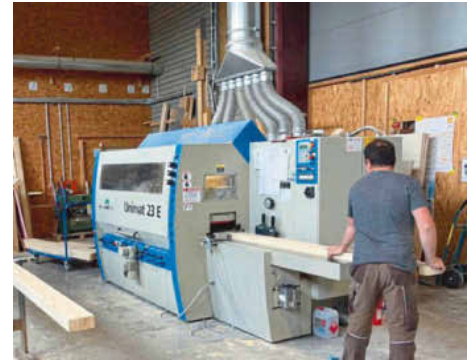
/ Aushobeln der Kanten an der Vierseitenhobelmaschine (hier: Unimat von Weinig).
